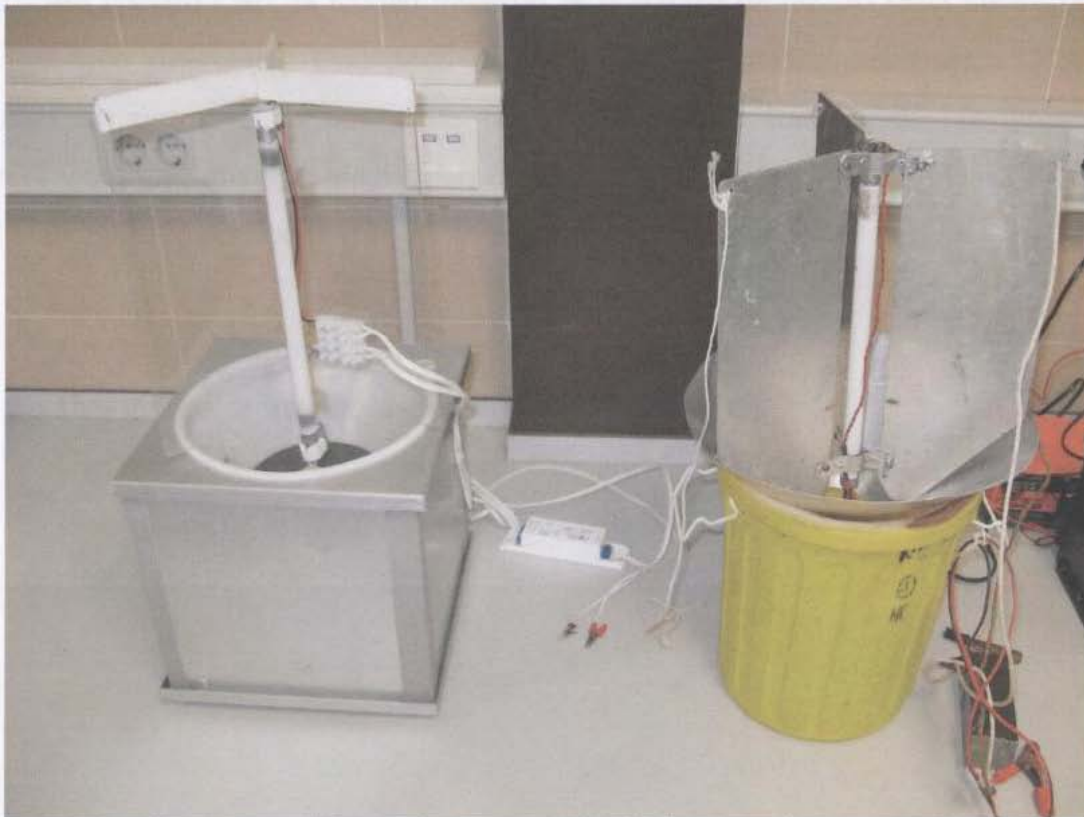
Fig. Trampas de luz. A la izquierda la de metal, y a la derecha la de plástico.
