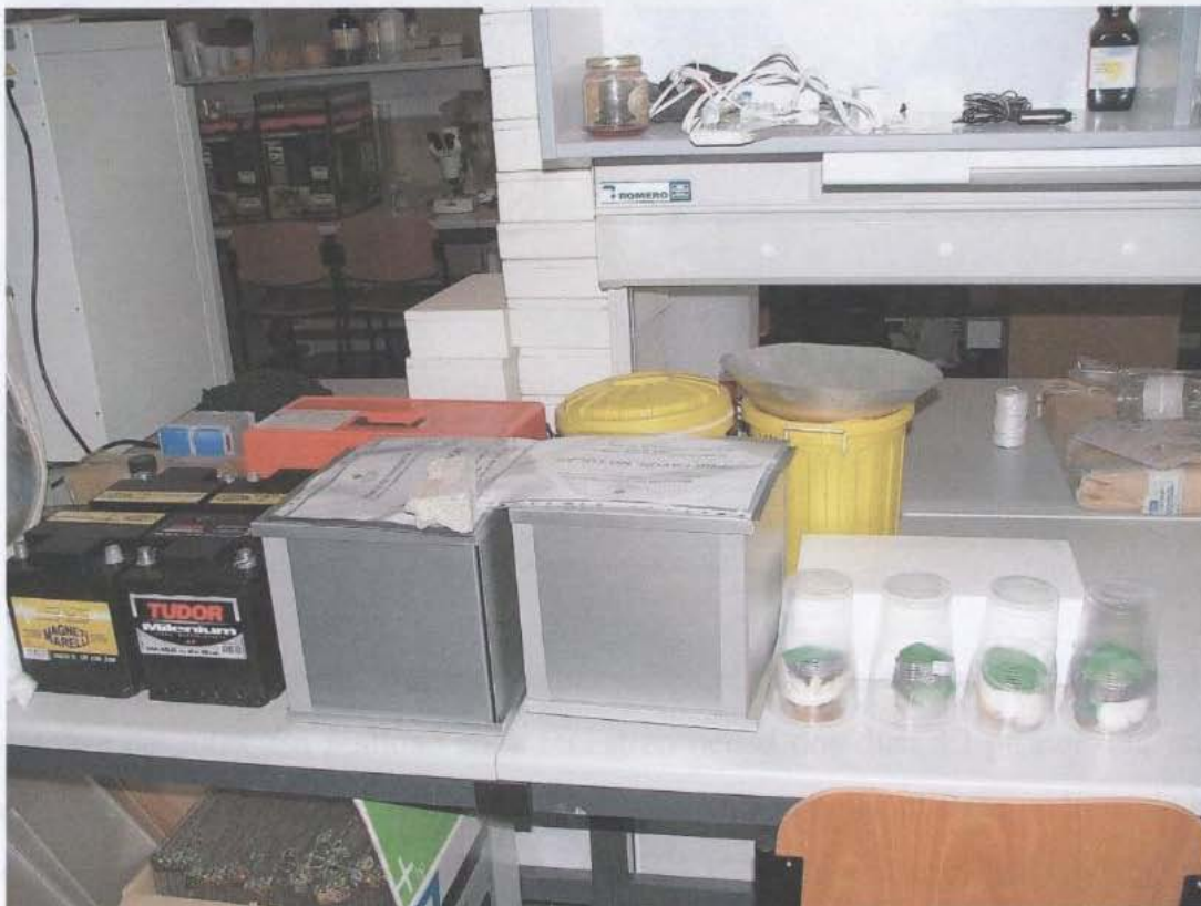
Fig. Equipo completo para el funcionamiento de las trampas de luz. A la izquierda las baterías, en el medio las trampas (con los cartones en su interior), y a la derecha los botes con el anestésico.
