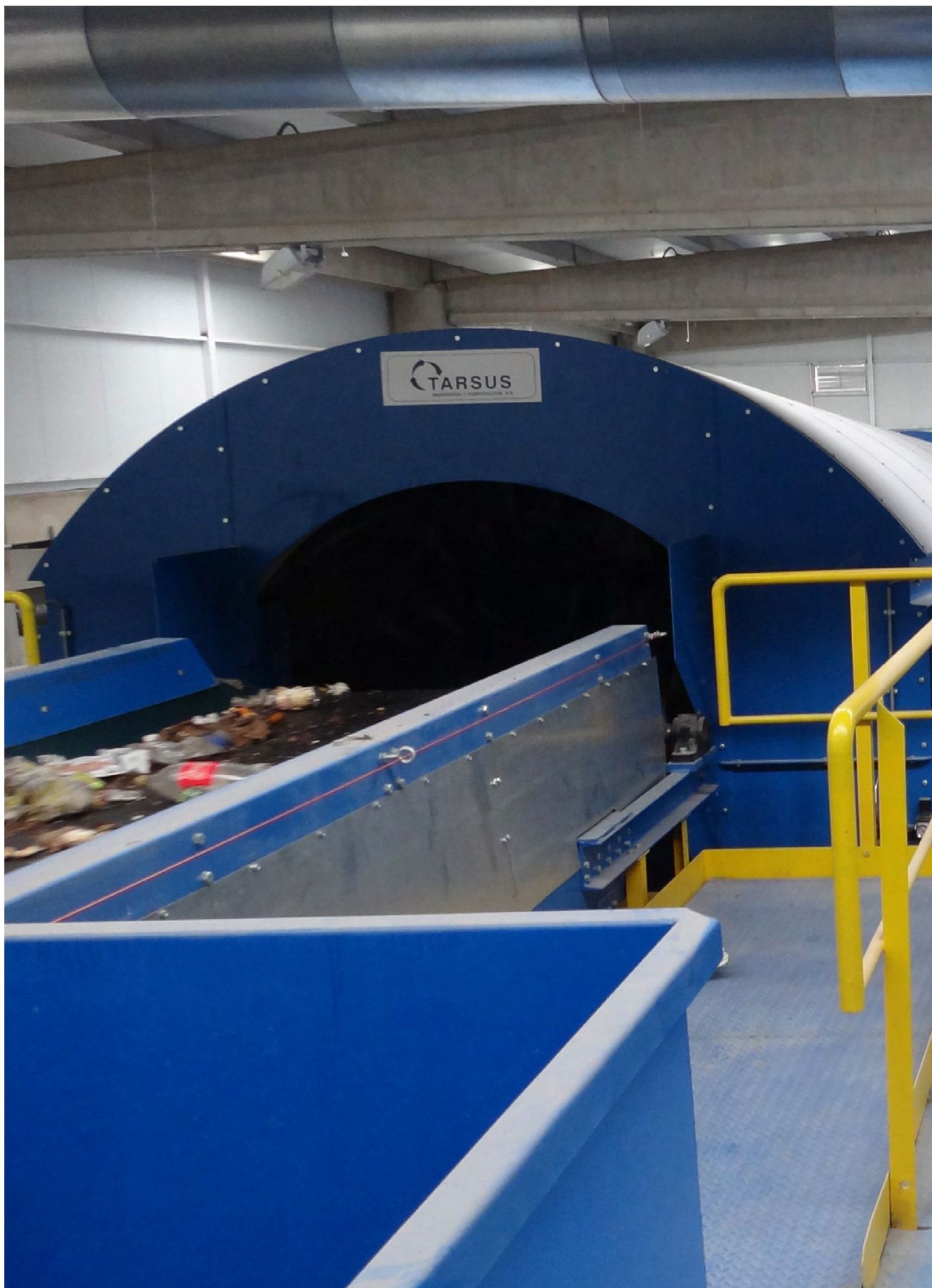
Los residuos, al llegar a la planta, pasan por una primera selección por volumen y peso, en el trómel (en la imagen). Fuente Infoenviro
